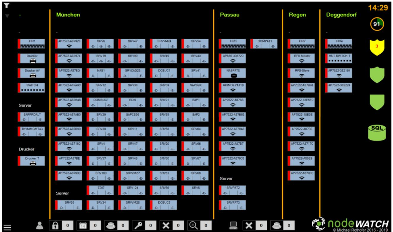
Das Filtersymbol oben links dient dazu, Nodes schneller zu finden, wenn schon sehr viele Geräte zur Überwachung angezeigt werden. Wenn man auf den Filter tippt, dann wird ein Eingabefeld eingblendet und eine Bildschirmtastatur erscheint.
